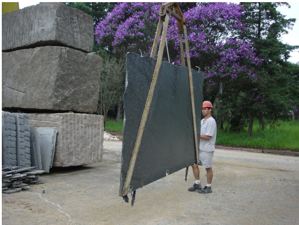
Transporte de uma Placa do Produto para Polimento
