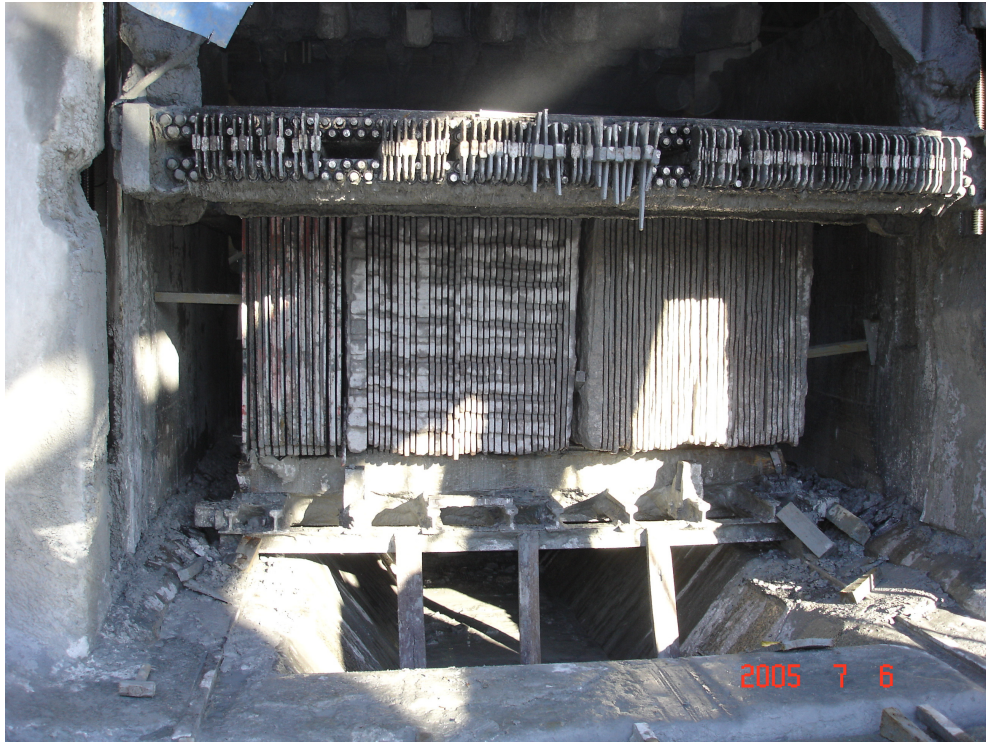
Bloco do produto (esquerda) em processo de corte no tear
