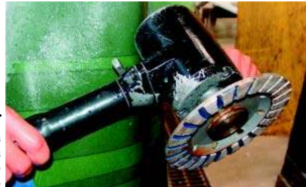
▶ Fig. 7: Lixadeira pneumática com disco de desbaste
