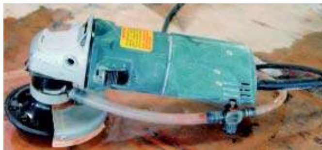
▲ Fig. 9: Lixadeira elétrica com alimentação contínua de água
