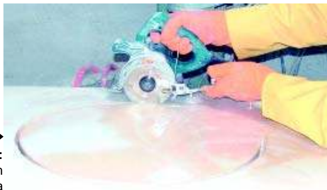
▶ Fig. 10: Serra manual elétrica com alimentação contínua de água
